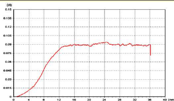
Curva de la fuerza de desacoplamiento en un desplazamiento de algunos cm. Se puede notar que cuando la calidad de la vulcanización es buena (como se muestra en este gráfico), la fuerza de desacoplamiento es constante, con una fuerza de separación promedio de 9 DaN por cada 10 cm de ancho.
